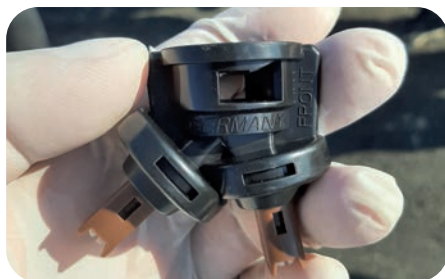
Пример сдвоенной насадки: двойной колпачок Agrotop ADF-cap с двумя форсунками Lechler IDK
