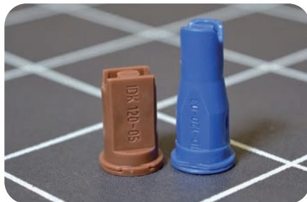
Сравнение размеров инжекторного короткого (Lechler IDK) и инжекторного длинного (Lechler ID) распылителей
