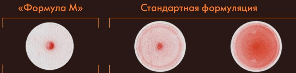
Отложение препарата (пыли) на фильтрованной бумаге после механического воздействия на семена
