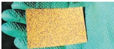
Водочувствительная бумага до и после опрыскивания (Spraying Systems Co.)
