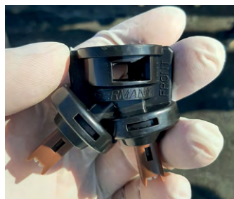
Пример сдвоенной насадки: двойной колпачок ADF-cap с двумя распылителями IDK
