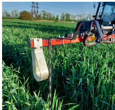
Кабельная стяжка — индикатор высоты штанги
